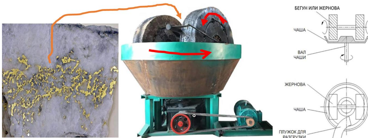
Рис. ТД3-02. Слева: так выглядит кварцевая руда с прожилками золота, которая добывалась в шахтах Кумака. Справа: бегуны – каменные колеса, насаженные на ось (в дело шли даже мельничные жернова). Они вращались вначале от конной тяги, затем в какие-то времена приводились паровыми, дизельными и даже электрические двигателями. В чаше кварцевая руда измельчалась бегунами практически до крупнодисперсного порошка
